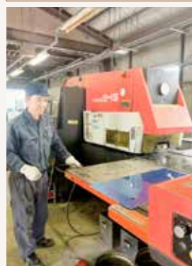
タレットパンチプレスによる ステンレス板の加工
