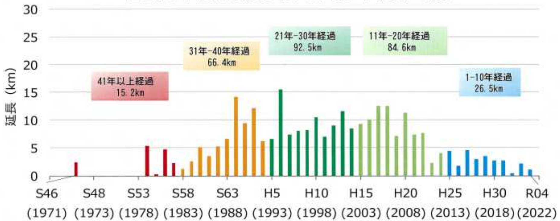
管路の布設年度別延長（令和4年度末時点）
