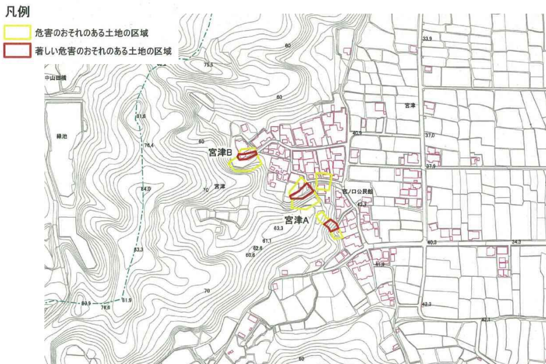
■図-2.1(20) 土砂災害警戒区域及び土砂災害特別警戒区域（宮ノ口：急傾斜）
