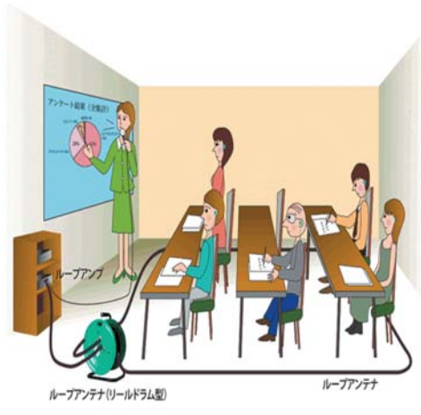
ループアンテナ(ドラム型) ループアンテナ 各会場に移動できる携帯型磁気ループ
