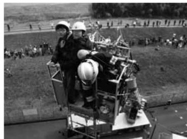
障害物等の影響を受けにくく、スムーズな救助活動が可能になる先端屈折型で、ポンプ車の機能も備えたはしご自動車を整備することで、消火救助機能の一層の向上を図る。
