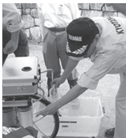
防災訓練の際に行われた自転車搭載型浄水器で飲料水をつくる様子
