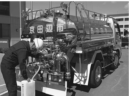
加圧装置を備えた新しい給水車。これまでは、1台の給水車で、1分間に350リットルを給水でき、高い所に水を供給する必要がある場合、必要に応じて、水をポンプアップして給水していました。新しい給水車は、30リットルのタンクに加圧ポンプを装備し、1分間に350リットルを給水でき、高い所に水を供給する必要がある場合、必要に応じて、水をポンプアップして給水することができます。また、地震などの大きな災害で断水になった時に、各給水拠点に水を配るなどの役目を果たすことができます。問合せ先 水道部(☎62-041)
